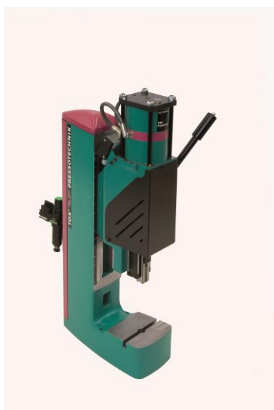
Bild 5 zeigt eine Pneumatikpresse TOX ® -FinePress PFHL
