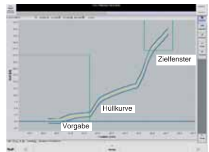
Bild 1: so einfach! Die Parametereingabe für den Clinch-Prozess direkt am Bildschirm. Bild 2 zeigt: Beispiele der zur Verfügung stehenden Bewegungsbeefehle.
