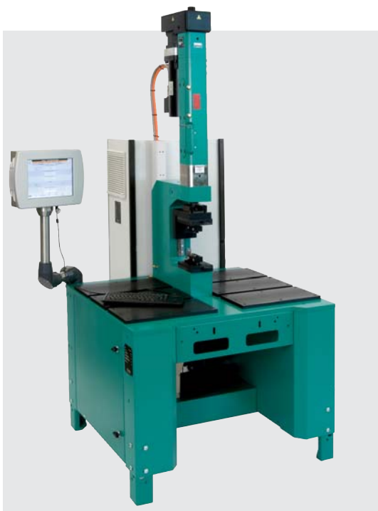
Ausführungsbeispiel: Presse aus Standardkomponenten auf Untergestell UUM
