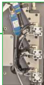
Vollstanzniet-Docking, hier für 3 Nietlängen
